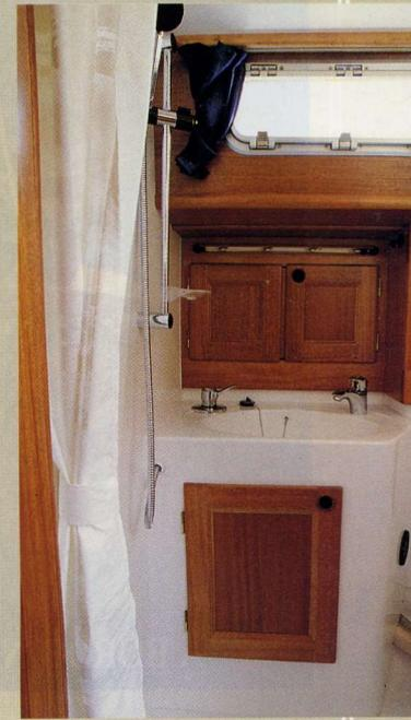
Aria minima letti: cm 40 - Ventilazione: ottima, grazie ad un portello di cm 68x35 (panca pozzetto) più due oblò apribili, di cm 55x15 e 35x15 - Illuminazione naturale: media, grazie ai due oblò - Illuminazione artificiale: media; una plafoniera alogena ed una luce di lettura alogena a doppia intensità luminosa (bassa/alta) - Volumi gavoni ed armadi: buoni - Vibrazioni motore in navigazione: limitate.
